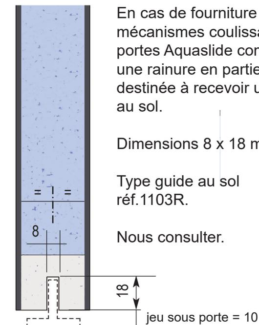
En cas de fourniture sans les mécanismes coulissants, les portes Aquaslide comportent une rainure en partie basse destinée à recevoir un guide au sol.
