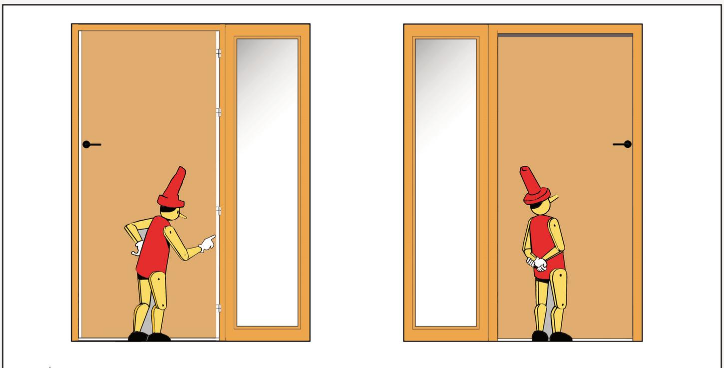
Côté INTÉRIEUR : des joints APD d'une largeur de 20 mm
